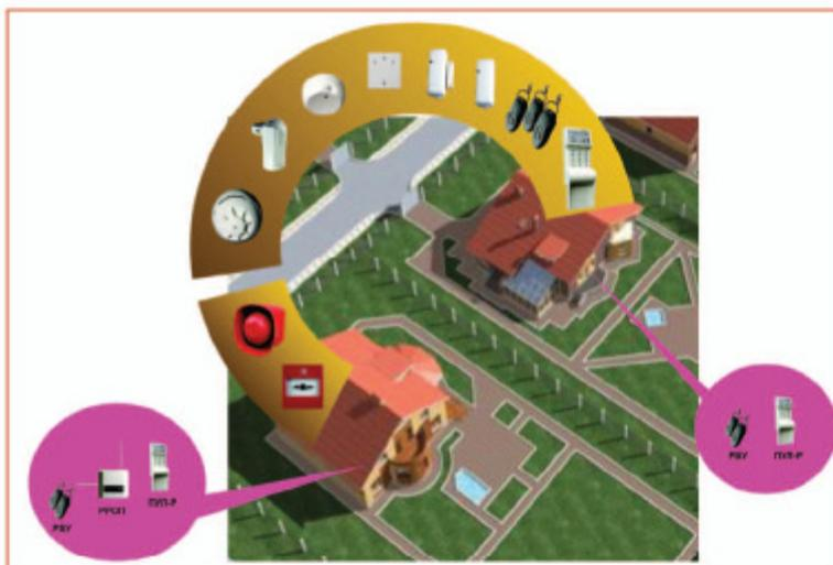
Рис. 5. Охрана нескольких соседних коттеджей с использованием одного радиорасширителя
