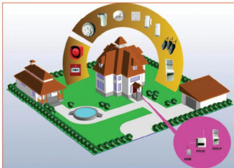
Рис. 4. Охрана коттеджа и вспомогательных строений с использованием одного радиорасширителя
